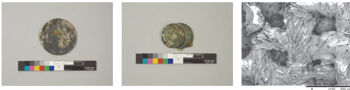
圖二二：分離鏽結的墨西哥銀幣（左）、方孔圓錢（中）， 以及纖維印痕的 SEM 顯微影像 (150 x)
